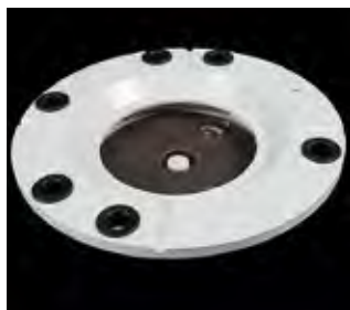
Установка Крепежный фланец может быть установлен с помощью 3х или 4х болтов М12 на окружности 200мм.
